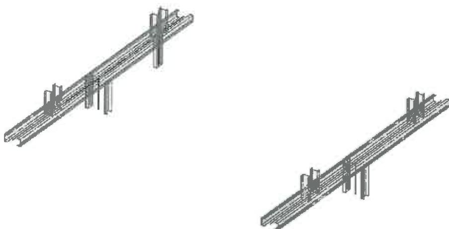
3. Опори 27-29 - съставена колона от 4L100x100x8мм 600x1000мм с хоризонтали и диагонали от 2L80x80x8мм, опорна греда 1000x600мм бетон C20/25, подколонници 1000x600мм на фундаменти 1800x1400x400мм, дълбочина 1,5м. Опорна греда и колонки 2UPN160x400mm.
