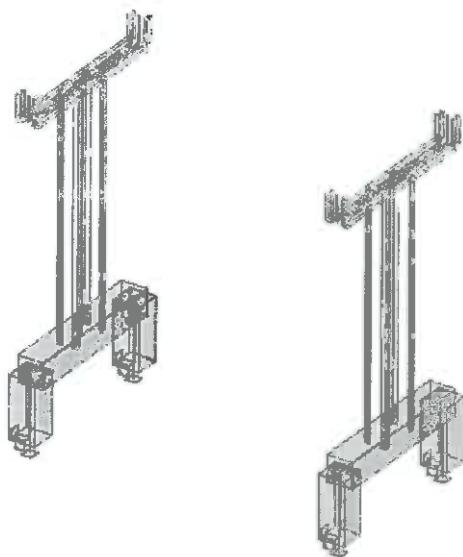
2. Опори вътре в сградата – 14-25, опорни греди 2UPN160x500mm, колонки, хоризонтали, диагонали със същото сечение:
